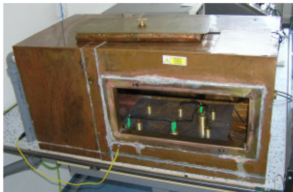
Obr. 6. Celkový pohled na vysokonapětový box pro pulzní namáhání.
