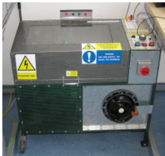
Obr. 3. Zařízení určené pro sinusové namáhání vzorků izolací.
